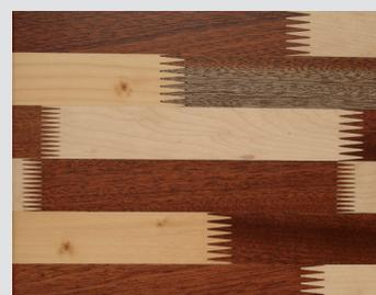
При помощи Z6+6 можно изготовить шипы различной длины, как с зазором у основания шипа так и без него
