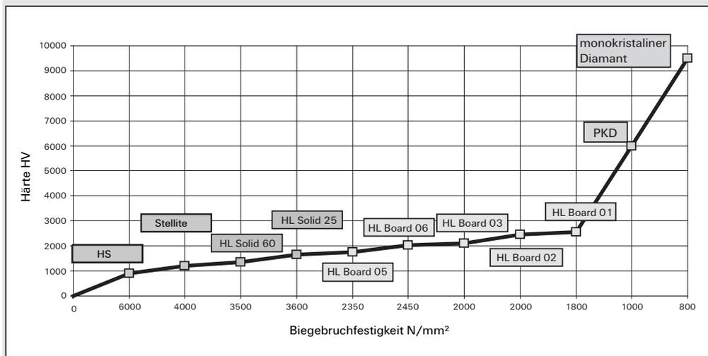
Hieraus läßt sich schließen, daß der Anstieg der Härte zwangsläufig mit einem Abfallen der Biegebruchfestigkeit verbunden ist. Oder mit anderen Worten: „Ein harter Schneidstoff braucht einen großen Keilwinkel.“
