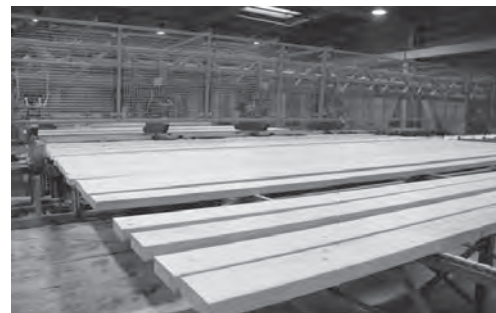
Po strugarce drewno konstrukcyjne jest cięte na żądaną długość.
