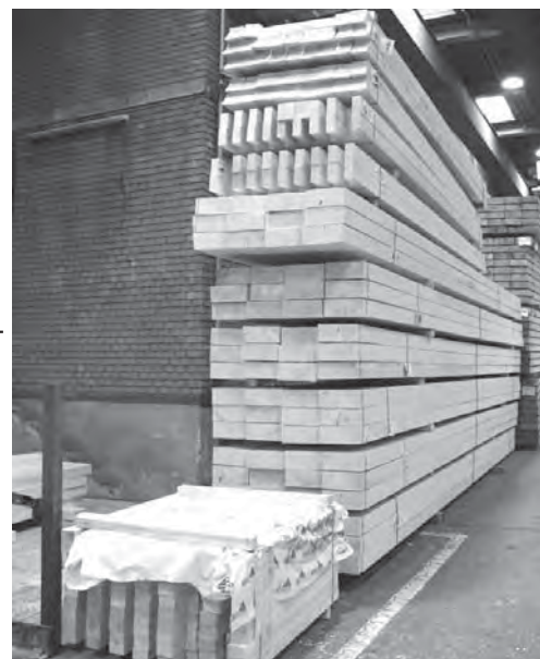
Po strugarce drewno konstrukcyjne jest cięte na żądaną długość.
