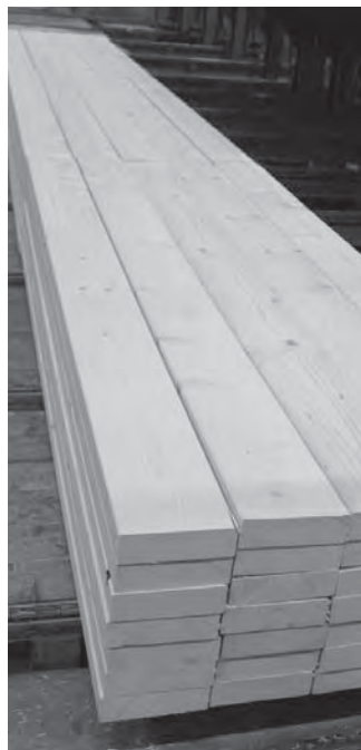
Po strugarce drewno konstrukcyjne jest cięte na żądaną długość.
