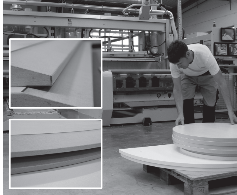
Sin astillas a pesar de la salida de la herramienta arriba del chapeado de canto y superficies lisas
