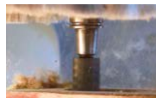
Unten: Spänestrahlführt ideal in Richtung Absaugung
