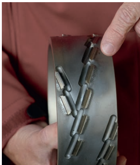
LEUCO p-System 70° Achswinkel ermöglichen „ziehenden“ Schnitt
