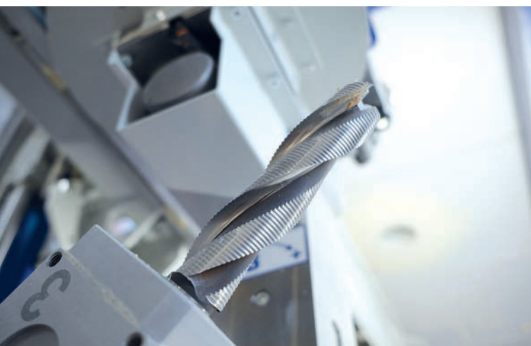
Der Schrupper wurde von LEUCO speziell für Krüsi entwickelt um die hohe Leistung nutzbar zu machen.
