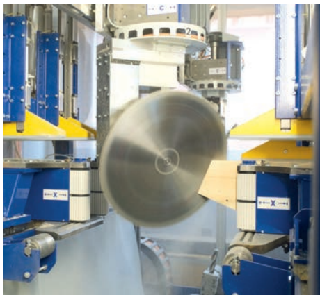
Die Werkzeuge sind in fünf Achsen ansteuerbar.
