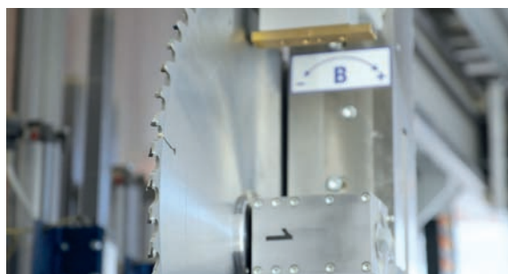
Die G5-Säge kann „wie gehobelt“ längs und quer schneiden.
