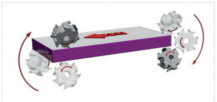
Schematische Darstellung der Bearbeitung von Kunststoff-Kanten – obere Ecke im Gegenlauf.
