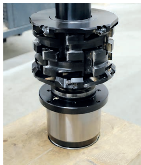
Toleranzen von wenigen Tausendstel ermöglichen die hohe Rundlaufpräzision, durch die eine sehr schöne Oberflächenqualität der erzeugten Blockbohlen erreicht wird.
