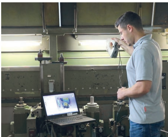
Eine hochpräzise Vermessung der Maschinenstraße ist die Basis für passgenaue, effiziente Absaughauben via 3D-Scan-Technologie.
