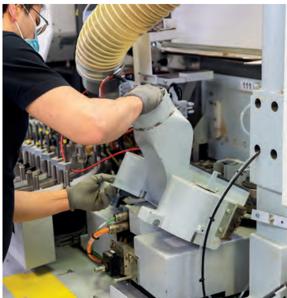
Zur Verstellung des Werkzeugs öffnet der Maschinenbediener lediglich die Haube. Das Werkzeug muss zur Verstellung nicht entnommen werden.
