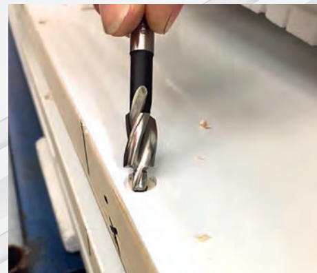
Ursprünglicher Zapfensenker zum Senken der Glasfaserdächer aus HSS
