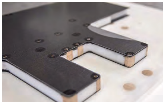
Zuschnitt von CFK mit dem diamantbestückten LEUCO nn-System DP Flex Sägeblatt
