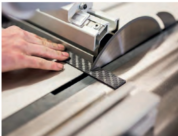
Zuschnitt von CFK mit dem diamantbestückten LEUCO nn-System DP Flex Sägeblatt
