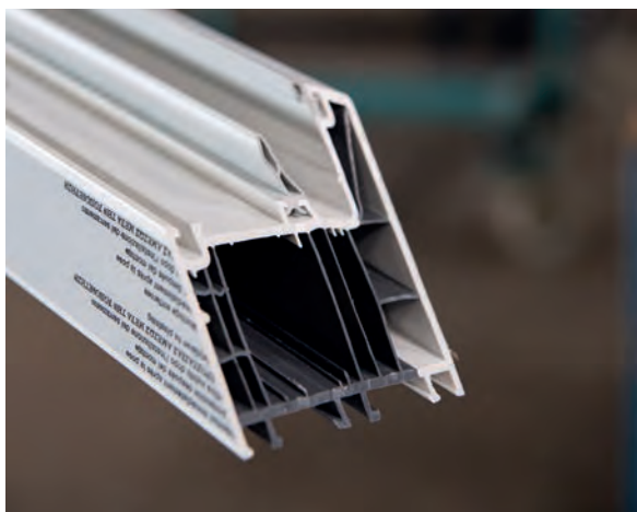
Schock Fensterwerk fordert saubere und gratfreie Kappschnitte, auch bei den bereits eingezogenen Dichtungen.
