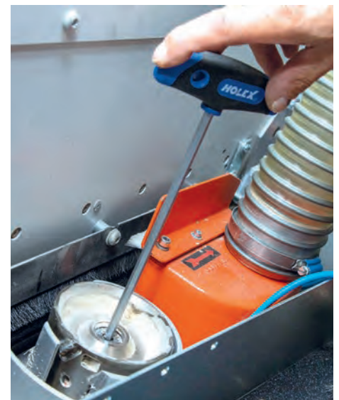
Hohe Präzision trotz einfachster Handhabung: Der Fügefräser DIAMAX AirStream HSK 32 F von LEUCO ist mit einem Inbus-schlüssel schnell in der Maschine gespannt.
