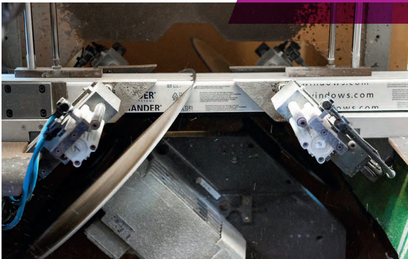
Auf drei Anlagen kappt Schock Fensterwerk Fensterprofile mit Standard- bzw. angepassten LEUCO-Sägeblättern mit langen Standwegen.
