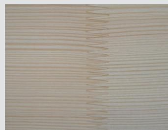
Dichtschließende Zinkenverbindung mit 10 mm
