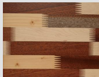
Mit dem Z6+6 können unterschiedliche Zinkenlängen mit und ohne Luft am Zinkengrund gefräst werden
