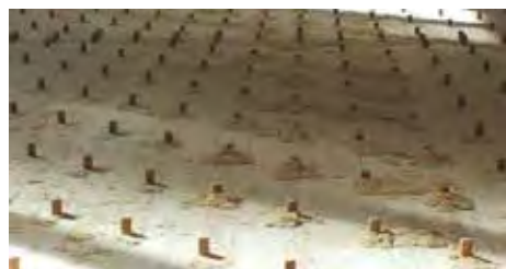
Alle vorgefertigten Elemente produziert Rombach in Oberharmersbach (Baden-Württemberg) aus massivem Holz leimfrei mittels Gewindestangen aus Buche. Die Bauweise ist patentiert und liefert verwindungssteife Bauteile gänzlich ohne Klebstoff.
