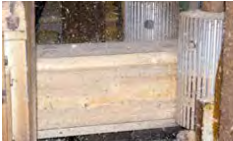
Mit bis zu 75 m/min fährt das Model durch den Fräser, der eine blitzsaubere Schnittkante hinterlässt
