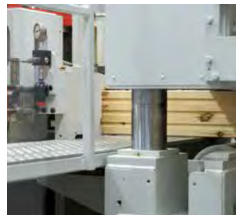
Mit zwei Vertikalwellen kann die Hobelanlage Blockprofile in einem Zug bearbeiten.
