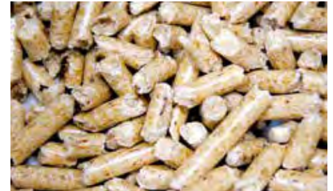
Im angrenzenden Pelletswerk werden die Späne zu EN-Plus-Pellets veredelt
