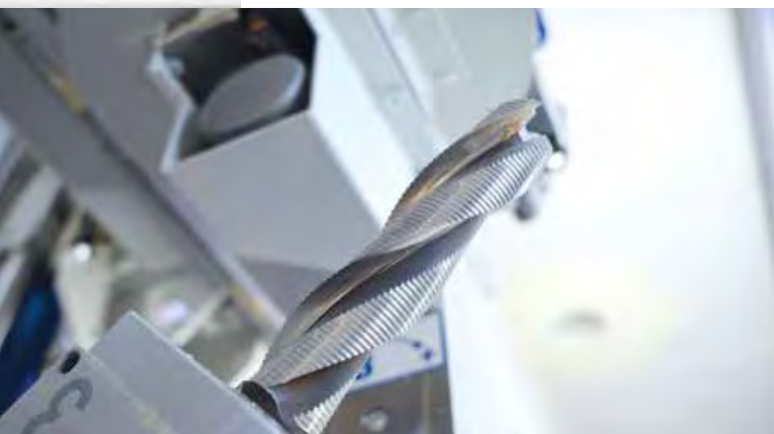
| Der Schrupper wurde von LEUCO speziell für Krüsi entwickelt um die hohe Leistung nutzbar zu machen.
