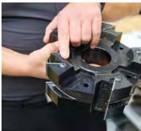
| Die Toleranzen der Plattensitze und Messer sind extrem gering.
