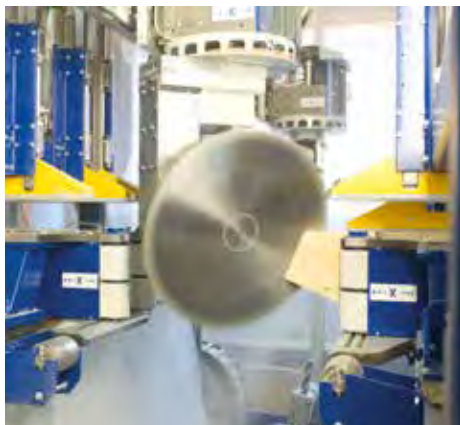
Die Werkzeuge sind in fünf Achsen ansteuerbar.
