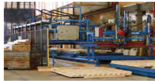
Ausschnitte für Fenster und Türen werden beim Legen der Brettlagen berücksichtigt und müssen später nur noch nachgefräst werden. Bei jedem Vor- und Rücklauf des Walzenfräasers mit dem Zerspanen im Gleich- und Gegenlauf kommt es zu zahlreichen Werkzeugein- und austritten. Mit dem LEUCO surfCut fräst Rombach mit 75% der möglichen Maschinenvorschubgeschwindigkeit.
