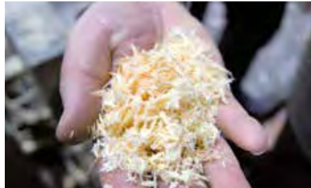
So fein kommen die Späne vom Eckenfräser und werden gesondert gesammelt
