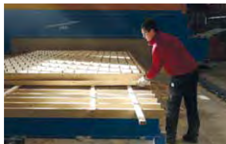
Die Arbeit auf dem Portalbearbeitungszentrum von Hundegger wurde mit dem „LEUCO surfCut“ von Holzbauer Rolf Rombach verbessert. Denn die Ansprüche seiner Kunden an die Oberflächengüte sind hoch und das Planfräsen der Elemente ist ein elementarer Arbeitsschritt, der mit dem neuen Werkzeug weniger Zeit beansprucht, im Bild Tobias Wehrle.
