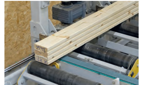
Die fertig gehobelten Profile weisen über Längen von bis zu 15 m eine Toleranz von 2/100 mm auf.
