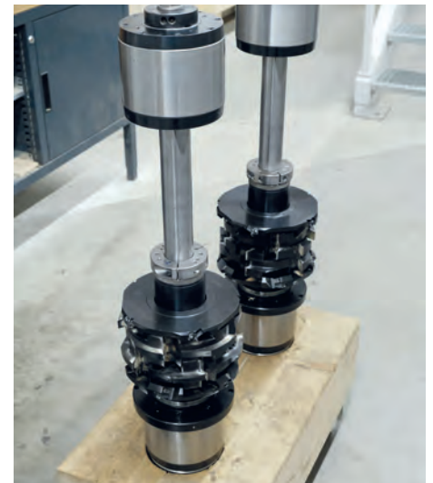
Wechselwellen der Hobelanlage, bestückt mit Vario 100 Werkzeugsätzen. Bis zu 300 mm Blockhöhe können bearbeitet werden.
