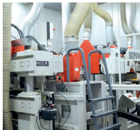
Die Anlage richtet die Seitenflächen ab, profiliert und hobelt danach Ober- und Unterseite.
