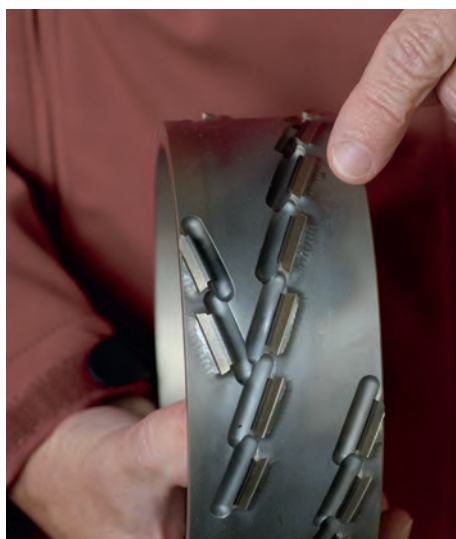
LEUCO p-System 70° Achswinkel ermöglichen „ziehenden“ Schnitt
