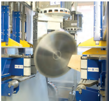
Die Werkzeuge sind in fünf Achsen ansteuerbar.
