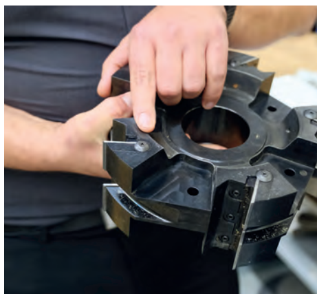
| Die Toleranzen der Plattensitze und Messer sind extrem gering.
