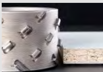
Fibonacci DIAREX airFace Z3+3 Fräser: Die Anordnung nach Fibonacci stellt sicher, dass kein Überschnittbereich vorhanden ist. Immer eine Schneide fräst exakt die obere Kante Werkstoffs ausrissfrei – das nennt sich Freiheit in der Höheneinstellung.
