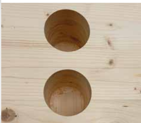
Hohes Spanvolumen schnell entsorgt und saubere Kante: Spiralförmiges Eintauchen ins Material mit dem t3-System-Multiblockfräser mit 10 Metern Vorschub und 8.500 Umdrehungen.
