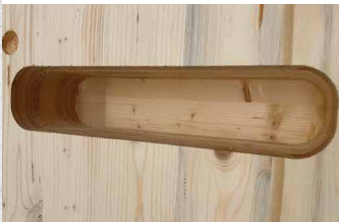
Hohes Spanvolumen schnell entsorgt und saubere Kante: Spiralförmiges Eintauchen ins Material mit dem t3-System-Multiblockfräser mit 10 Metern Vorschub und 8.500 Umdrehungen.
