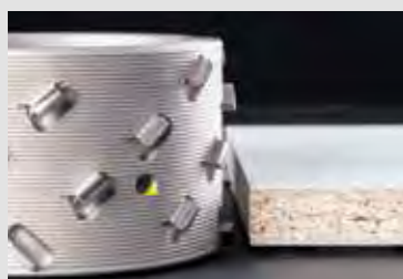
Fibonacci DIAREX airFace Z3+3 Fräser: Die Anordnung nach Fibonacci stellt sicher, dass kein Überschnittbereich vorhanden ist. Immer eine Schneide fräst exakt die obere Kante Werkstoffs ausrissfrei – das nennt sich Freiheit in der Höheneinstellung.
