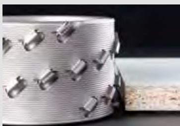
Standard DIAREX airFace Z3+3 Fräser - Eingriff der Schneiden in die Platte. Höheneinstellung des Fräasers zur 19 mm Platte muss genau erfolgen, dass der Überschnittbereich nicht die obere Melaminschicht erfasst.
