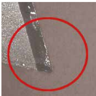
Hat Ausdauer für Langstrecke: Die Kantenverrundung eines Diamant-Sägezahns nach 80 km Schnittweg.
