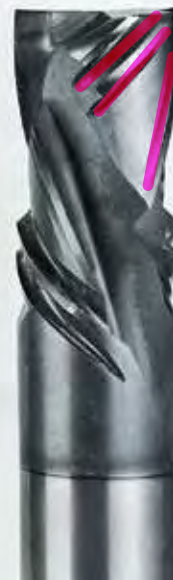
Der Name „Trio“ beschreibt die neue Technik mit drei unterschiedlichen Achswinkeln auf demselben Flugkreis. Die Präzision und Power des Trios überzeugt: So war ein Fräser bei 3 mm Abtrag an einer 19 mm Magnethaftplatte nach über 2500 Laufmetern noch nicht am Ende seiner Standzeit angelangt.
