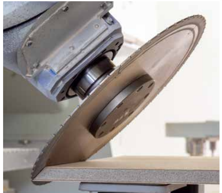
LEUCO nn-System auf der CNC: sauberer Gehrungsschnitt in beidseitig furniertem Blähglas
