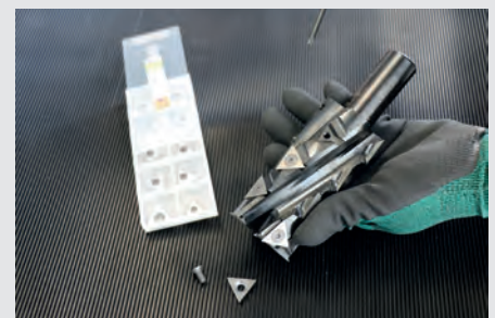
Mit einem Inbus lassen sich alle 18 Platten inkl. Reinigung in 10-15 Min wechseln.
