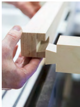
Schwalbenschwanz-Zapfen und Schwalbenschwanz-Schlitz mit p-System Schwalbenschwanzfräser erstellen
