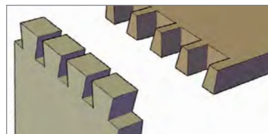
Schwalbenschwanz-Zapfen mit dem p-System Schwalbenschwanzfräser fräsen
