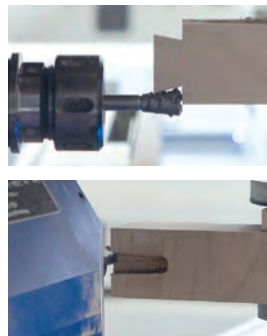
Schwalbenschwanz-Zapfen und Schwalbenschwanz-Schlitz mit p-System Schwalbenschwanzfräser erstellen
