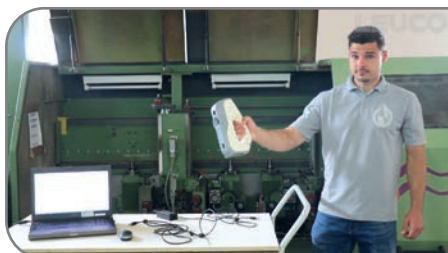
Eine hochpräzise Vermessung der Maschinenstraße ...
