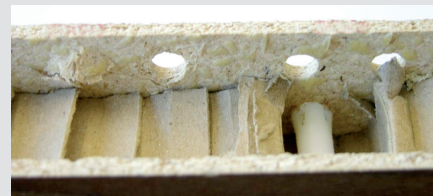
Bohrervergleich links: Standardbohrer rechts: LEUCO VHW-Dübelbohrer
