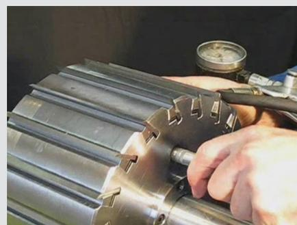
Flinker Messerwechsel dank dem Schnellspannsystem
