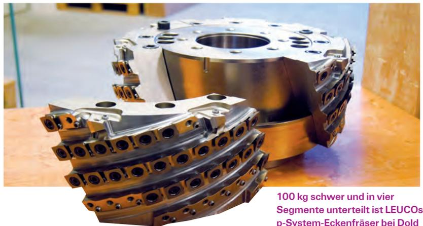
100 kg schwer und in vier Segmente unterteilt ist LEUCOs p-System-Eckenfräser bei Dold
