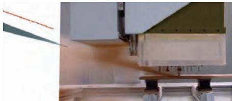
Der gezielte Spänestrahl durch die optimierte „LEUCO CM“-Schneidenanordnung ist beim Fräsvorgang deutlich erkennbar.
