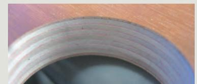
Neu: Ausparung in der gleichen Pappelsperholzplatte mit einem diamant-bestückten LEUCO p-System Werkzeug bearbeitet. Es ist deutlich sicht- und fühlbar, dass alle Schichten eine saubere, glatte Oberfläche haben, trotz der schwierigen, faserigen Holzart Pappel.
