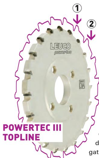
Seit der Markteinführung hat sich dieser Zerspaner als eines der meistverkauften Zerspanersysteme am Markt etabliert. Grundlegende Unterscheidung zu den PowerTec Vorgängern ist, dass Finish-Schneide (Spanwinkel negativ) und Vorzerspannschneide (Spanwinkel positiv) in einem Spanraum integriert sind.
