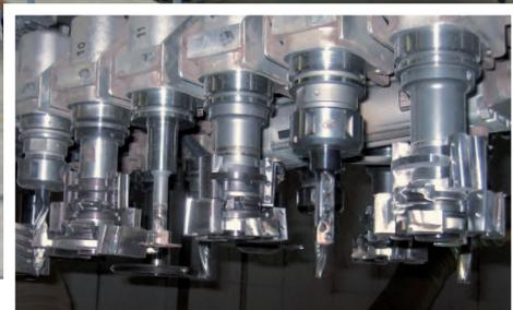
einem größerem Durchmesser sind auf 13.000 U/min reduziert und erreichen bei gleicher Schnittleistung einen Vorschub von 7,8 m. Die Leistungssteigerung macht also ansehnliche 11 % aus.
