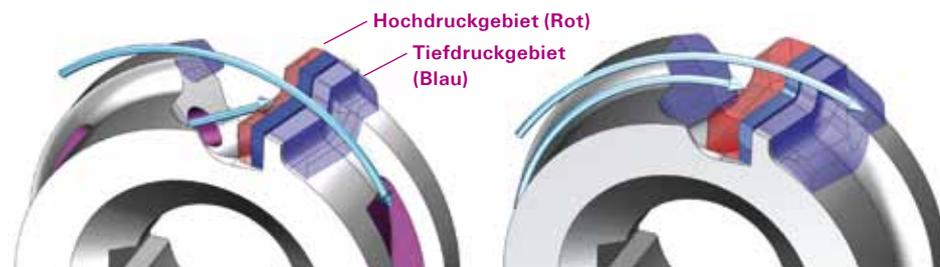
Luftdruckgebiete am Standardwerkzeug (links) und am AirStream-Werkzeug (rechts)
