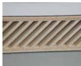
Wabenplatte mit eingesetzter Stützkante
