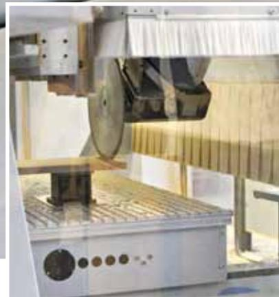
Einsatz zum Nuten auf der CNC. Hier führt Wochner auch Schifterschnitte aus
