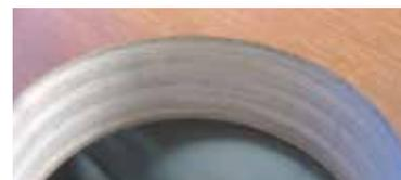
Neu: Ausparung in der gleichen Pappelsperholzplatte mit einem diamantbestückten LEUCO p-System Werkzeug bearbeitet. Es ist deutlich sicht- und fühlbar, dass alle Schichten eine saubere, glatte Oberfläche haben, trotz der schwierigen, faserigen Holzart Pappel.
