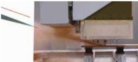
Der gezielte Spänestrah durch die optimierte „LEUCO CM“-Schneidenanordnung ist beim Fräsvorgang deutlich erkennbar.
