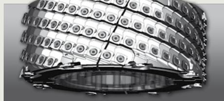
LEUCO p-System Eckenfräser mit auswechselbaren Wendeschneidplatten, die unter einem hohen Achswinkel angeordnet sind. Das Werkzeug ist aus austauschbaren Segmenten aufgebaut.
