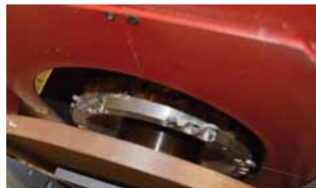
**Dieser Ritzerspanner trägt die verschiedenartigen Deckschichten und Trägerlaminare in einer Stufenschnittausführung von außen nach innen ab und verhindert damit in der Querverarbeitung ein Ausreißen an der Hinterkante.**
