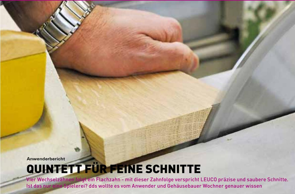
Ohne Unterlegholz erzeugt das G5-Sägeblatt auf der Formatkreissäge hervorragende Hirnholzchnitte
