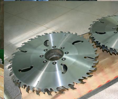
Die Grundkörper der Vorschnitt-Kreissägen von LEUCO sind hinterdreht, wodurch das Ausräumen der Späne durch den Spanräumer erleichtert wird
