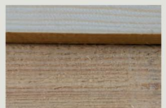
Das Schnittbild der Lärche zeigt, wie sauber das Sägeblatt beim Sägen längs zur Faser arbeitet.
