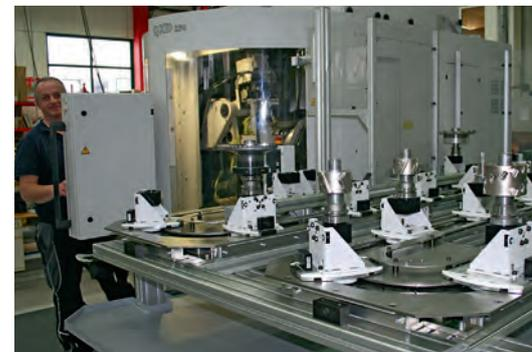
Ein Mitarbeiter bedient die Erodieranlage, welche über das Werkzeugmagazin automatisch be- und entladen wird
