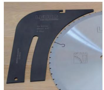
Um mit dem nn-System erfolgreich arbeiten zu können, muss der passende Spaltkeil verwendet werden. Er sollte für diese Sägeblätter 2,0 bis 2,4 mm dick sein.
