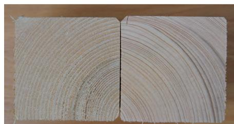
Zwei Schnittflächen im Vergleich. Die linke entstand nach einem Sägeschnitt mit dem nn-Sägeblatt, die rechte mit einem herkömmlichen Sägeblatt für Massivholz quer.
