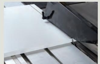
Beim Sägen kunststoffbeschichteter Plattenwerkstoffe ohne Vorritzer macht das Sägeblatt eine gute Figur.
