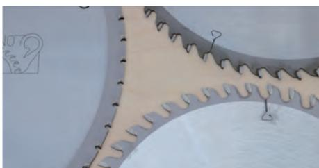
Zahnvergleich: Links das nn-System, rechts unten das Sägeblatt für Massivholz quer zur Faser und rechts oben das für Plattenwerkstoffe.
