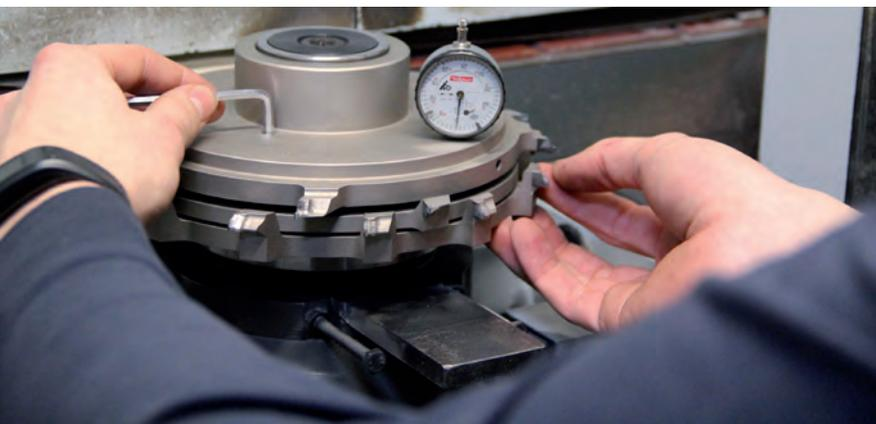
Der zusammengesetzte, verstellbare Diamant-Profilfräser braucht eine hohe Laufruhe, um gleichbleibende anspruchsvolle Qualität zu liefern. Deshalb wurde das Werkzeug auf hochpräzisen Hydrobuchsen montiert.
